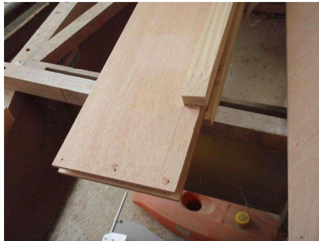
同様にボトムパネルを重ね合わせ、エッジに10センチ間隔でドリルで穴を開け、ボトムの中心を針金で仮止めしていきます。
