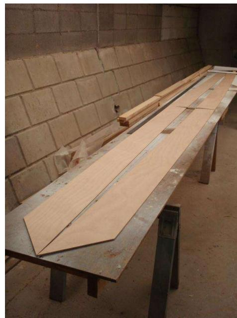
設計図どおりのサイズで机に印をつけ、そこのパネルを置いて釘打ちし、仮固定します。設計図はインチ表示なので毎度換算が必要です。エポキシの接着剤を作つてから2枚のパネルを接着。
