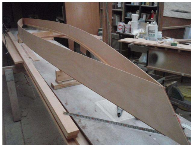
その上にボトムパネルを置きます。針金で接合した2枚の板を広げるようにかぶせます。
