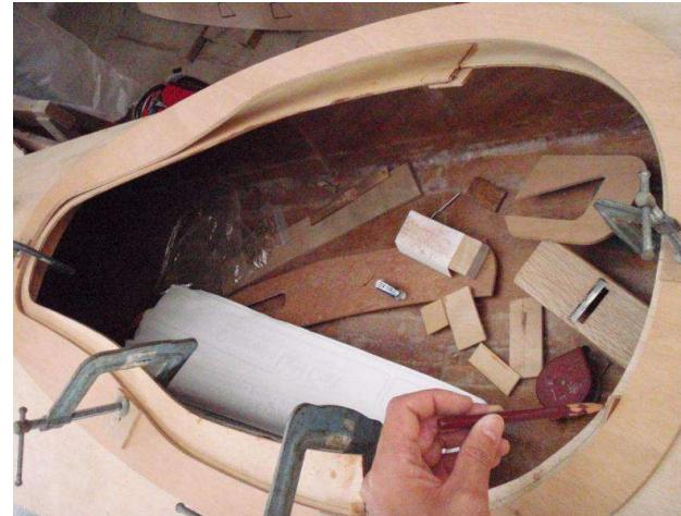
コーミングを2枚重ねて張り付け、クランプで前後を固定。前側にボルトを打って固定します。
