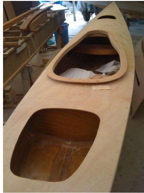
カットした部分にデッキの下から補強の板をとりつけ、デッキ上に細いシーム板を取り付けてサンドします。
