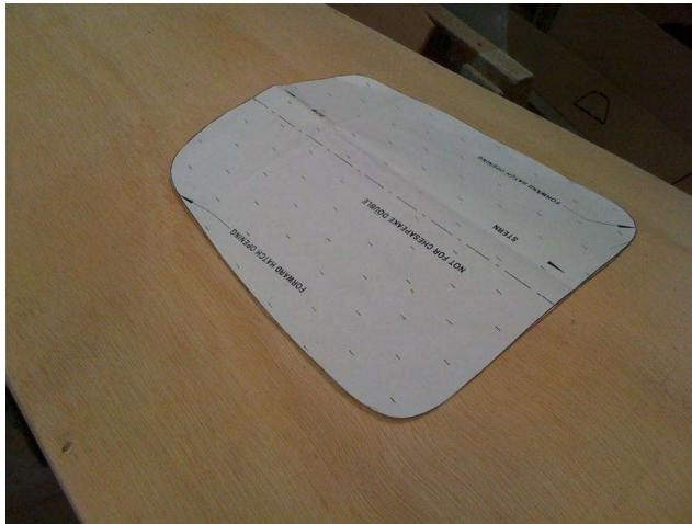
ドリルで穴を開け、ジグソーでカット。急なカーブ箇所は細めの刃に付け替えます。
