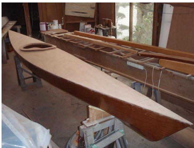
最後にフットブレースの台座を残材を使って作ります。
