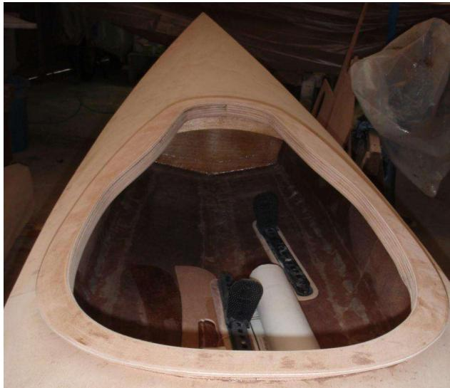
そして、デッキのエッジを丸みを持たせるよう軽くカンナで削ってから、サンディングしてきれいなカーブを作るようにします。
