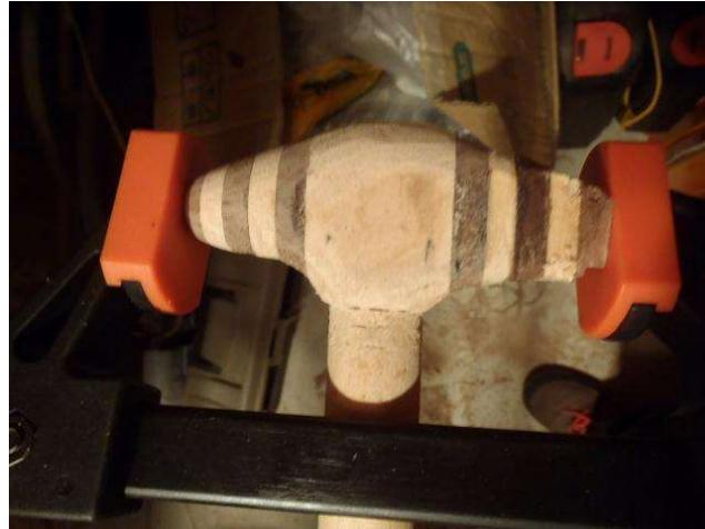
ここで、ブレード面の板と板の継ぎ目の段差を念入りにサンディングします。
