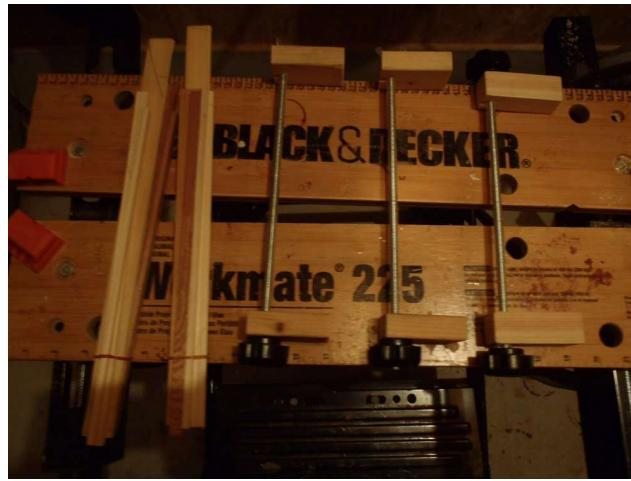
写真左側： グリップ部の製作。こちらも板材の余りを積層して接着します。
