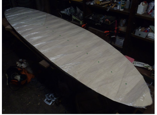
それからレール側には簡易クランプを取り付けて固定。
