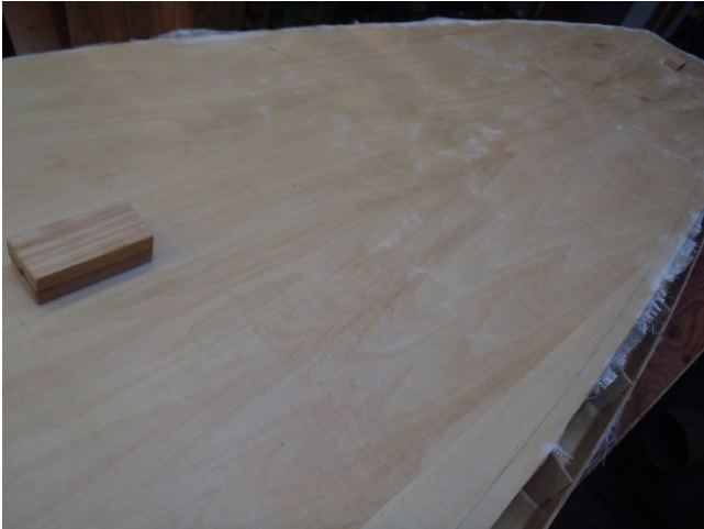
フレーム面をサンディングしてからボトム板と接着。
